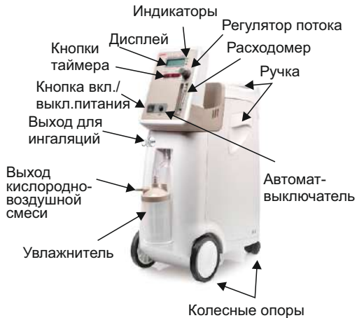
Рисунок 2 - основные элементы концентратора вариантов исполнения 9F-3W, 9F-5W
